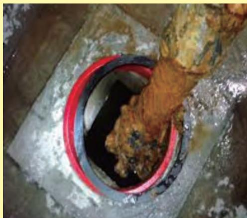
サビが固着した従来型フート弁 (従来型の末端に使うフート弁は水中に取り付けるため、サビが発生しやすい。)
